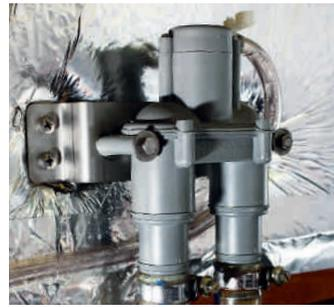
**Belüftungsventil** Lässt Luft in das System und verhindert so durch den Hebereffekt rücklaufendes Kühlwasser im Motor
