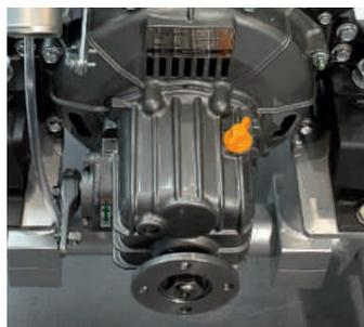
**Getriebe** Übersetzt die Motordrehzahl in eine niedrigere, zu Booten passende, und ermöglicht das Fahren achteraus
