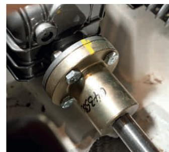
**Wellenkupplung** Kann starr, wie hier, ausgeführt sein. Besser ist eine flexible Kupplung, die Motorvibrationen absorbieren kann
