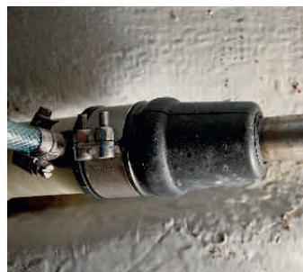
**Wellendichtung** Führt die sich drehende Welle durch den Rumpf und dichtet diese mit flexiblen Lippen gegen Außenwasser
