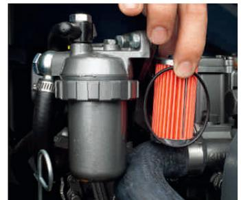
**Feinfilter** Unmittelbar vor der Einspritzpumpe montiert. Ersatzfilterelement sollte an Bord sein. Oben: Entlüftungsschraube
