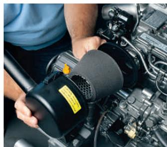
**Luftfilter II** Bei Yanmar lässt sich das Filterelement entnehmen und reinigen. Es darf keinesfalls nass eingebaut werden
