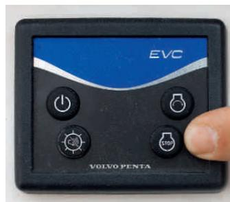
**Motorpaneel I** Im Uhrzeigersinn: einschalten, vorglühen und starten sowie abschalten. Links unten: Alarm quittieren
